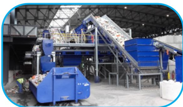
Ce centre de tri dispose d'équipements innovants permettant de traiter le nouveau flux ECT - « extension des consignes de tri » - Des trieurs optiques, des cribles balistiques et un tri manuel assurent la séparation de tous les déchets recyclables par catégorie.
